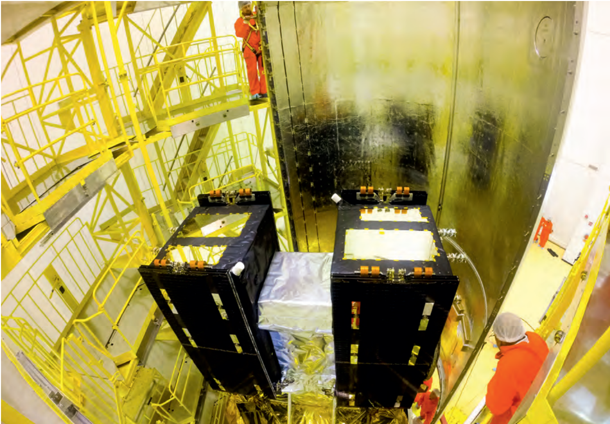
Einbau der Galileo Navigationssatelliten 9-10 in die Sojus-Halterung
